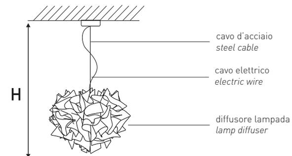
Per decidere l'altezza della lampada è necessario regolare sia la lunghezza del cavo d'acciaio che del filo elettrico.
