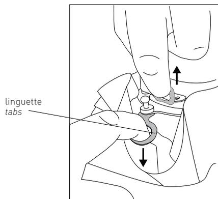
Per staccare il diffusore, aprire il fermo di sicurezza ed utilizzare il sistema di attacco magnetico utilizzando sempre le linguette come mostrato in figura.
