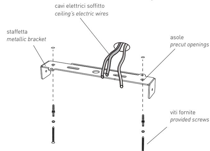
Forare il soffitto in due punti secondo le asole predisposte sulla staffetta e fissare quest'ultima con le viti fornite. Attenzione a non bloccare i cavi provenienti dal soffitto.
