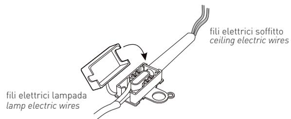
Rimettere in sede il tubicino e i cavi avvitati tramite il connettore all'interno della loro sede nella scatola. Chiudere il coperchio a pressione e re-inserire il tutto all'interno della coppetta.
