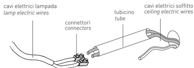
Inserire i fili elettrici provenienti dal soffitto nel tubicino. Allentare le viti del connettore per permettere l'ingresso dei cavi elettrici del soffitto per connetterli ai cavi elettrici della lampada. Stringere le viti per fissare la connessione.
