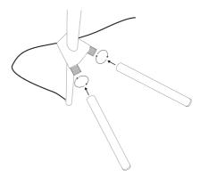
2) Raccorder le cordon d'alimentation au boitier de la prise et choisir la fiche adaptée à votre région. / Connect the power cable to the power box and choose the adapted plug according to your location.
